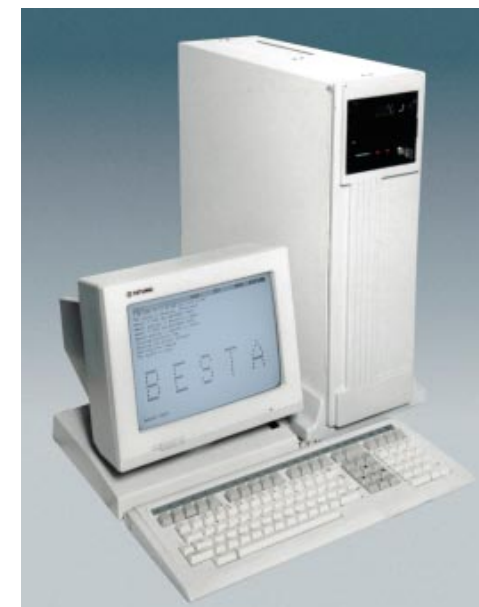
Известность институту принесло создание в 1986–89 годах первой отечественной многопользовательской ЭВМ «БЕСТА» класса «рабочая станция» с процессором MC68020, шиной VME и ОС Unix. Некоторые из этих станций успешно эксплуатируются до сих пор
